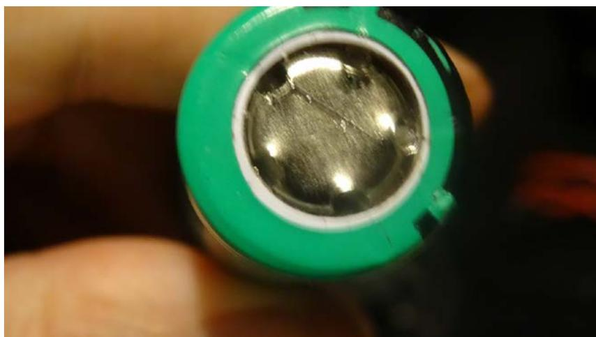
Померив напряжение, обычно равно нулю, начинаем процесс восстановления LiPo аккумулятора.
