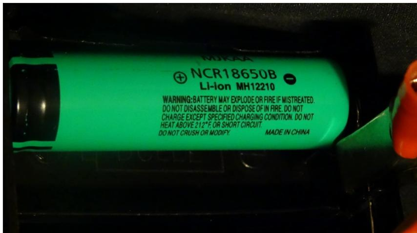
Бывают случаи когда во время зарядки литиевого аккумулятора закорачивает электролит или смещается одна из контактных шайб. Аккумулятор сильно нагревается! Если этим все заканчивается то есть реальный шанс его восстановить.
