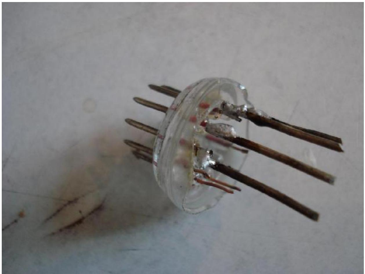
**Далее я развёл немного автомобильной шпатлёвки и замазал ножки. Далее всё понятно из фотографий.**
