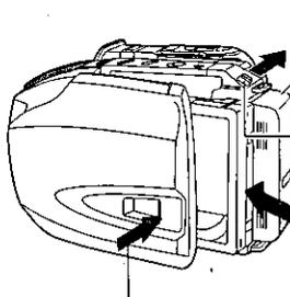
1 Coloque la **batería** cargada.
