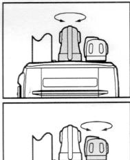
□ Вращением ручки VOL/PWR установите желаемый уровень громкости. Если сигнал отсутствует, нажмите и удерживайте кнопку МОНИТОР в течение 1 секунды (нижняя кнопка на левой стороне). При этом будет слышен собственный шум приемника, что позволит Вам установить желаемый уровень громкости.
